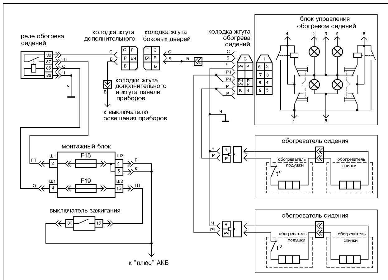
Рис.8 Схема электрических соединений обогревателя сидений на а/м ВАЗ-2110.
