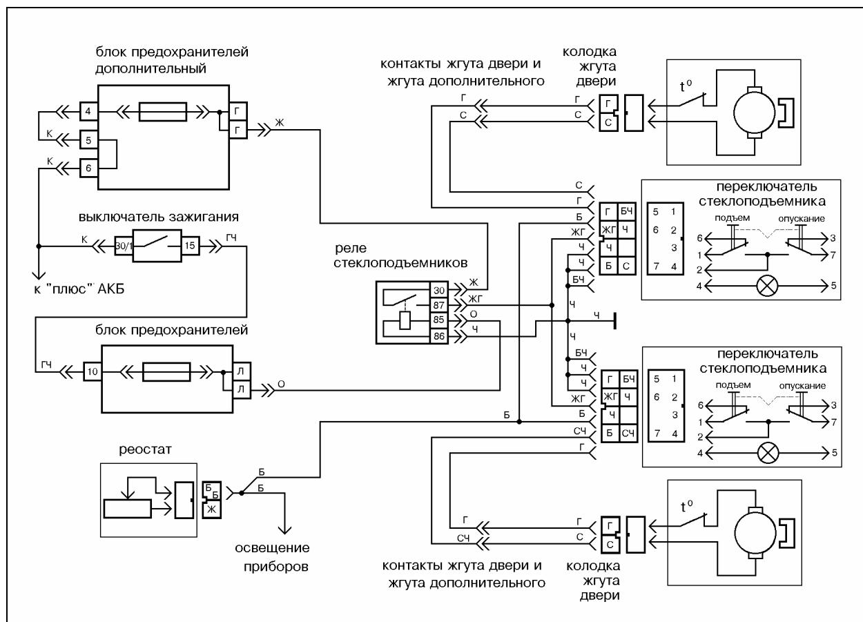
Рис.2 Схема электрических соединений электростеклоподъемников на а/м ВАЗ-2106.
