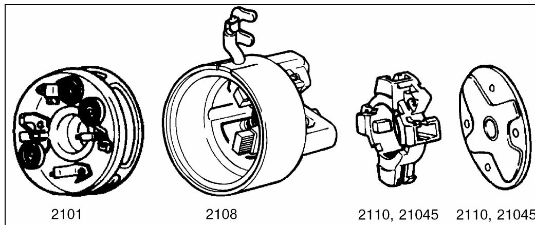
Рис.8 Задние крышки и щеткодержатель.
