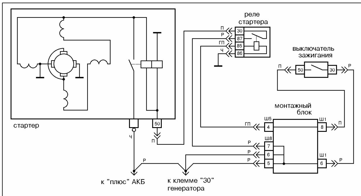
Рис.15 Схема электрических соединений стартера 2108-3708010 на а/м ВАЗ-2108, 2109, 21099.
