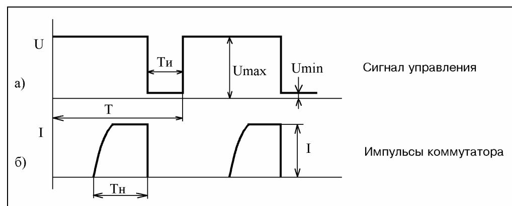
Рис.25 Осциллограммы импульсов сигнала управления и коммутатора.
