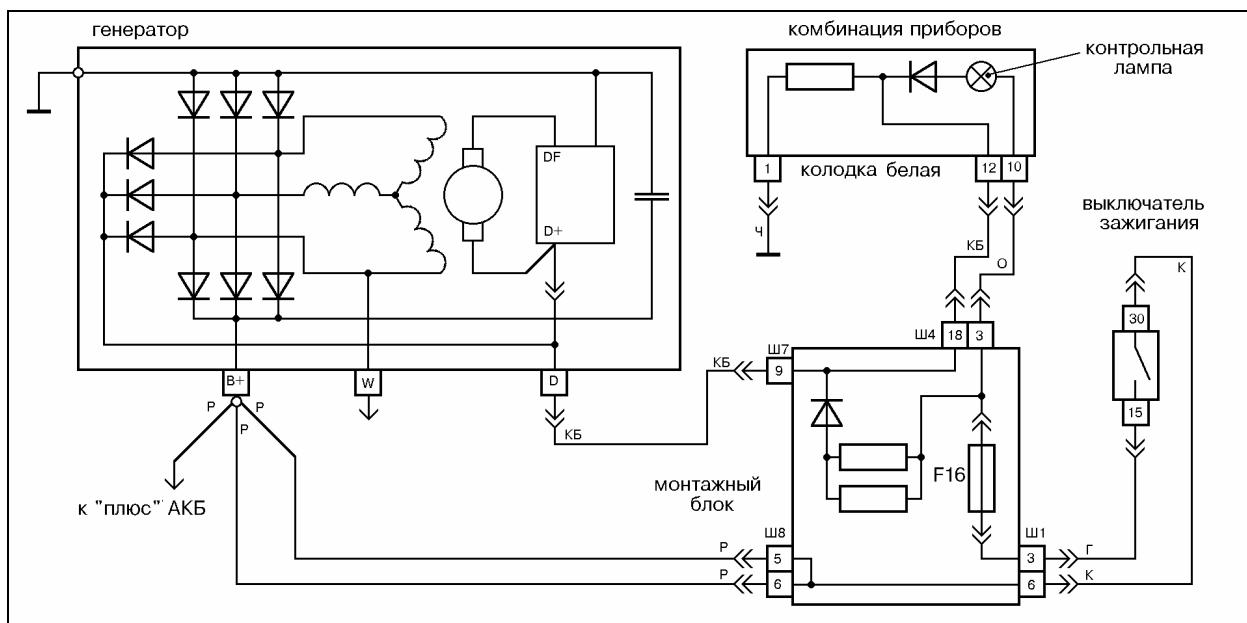
Рис.21 Схема электрических соединений генератора 2112-3701010 на а/м ВАЗ-2115.
