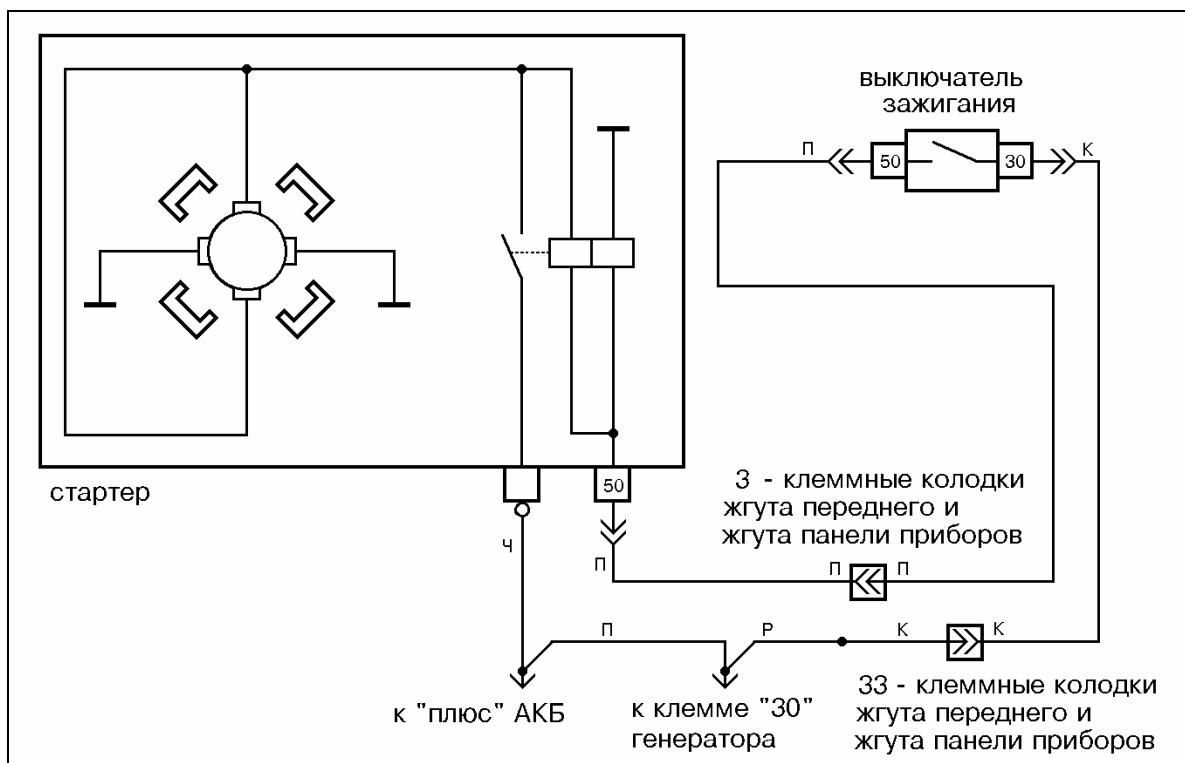
Рис.18 Схема электрических соединений стартера 21213-3708010 на а/м ВАЗ-2123.
