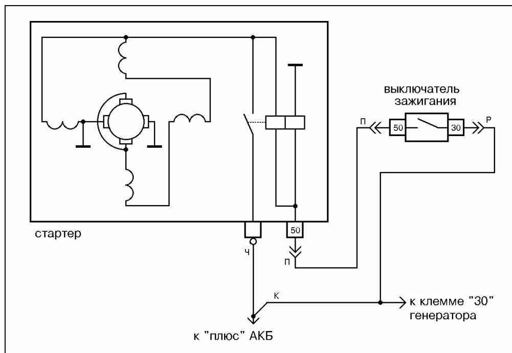
Рис.12 Схема электрических соединений стартера 2101-3708000-02 на а/м ВАЗ-2106.
