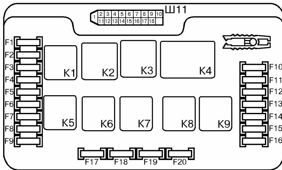
Рис.13. Расположение реле и предохранителей в монтажном блоке 2114
