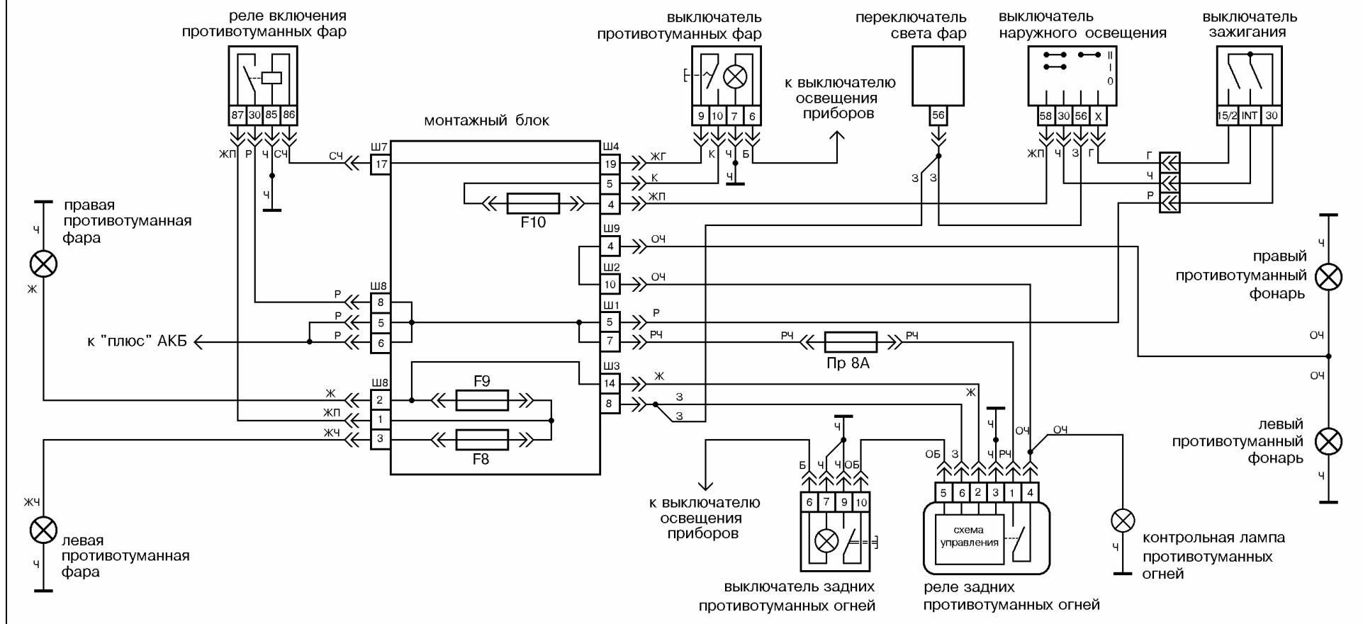
Рис.10 Схема включения задних противотуманных фонарей на а/м ВАЗ-21083, 093, 099.
