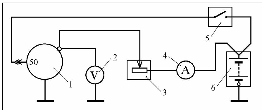
Рис.19 Схема соединений для стендовой проверки стартера.
