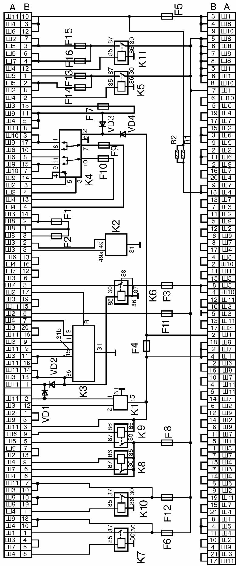
Рис. 7. Принципиальная схема внутренних соединений монтажного блока 2108.
