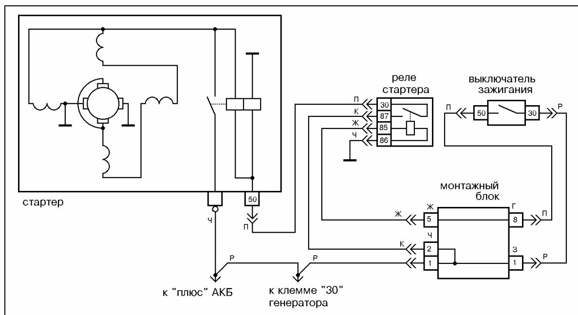
Рис.13 Схема электрических соединений стартера 2101-3708000-02 на а/м ВАЗ-2104, 2105, 2107.
