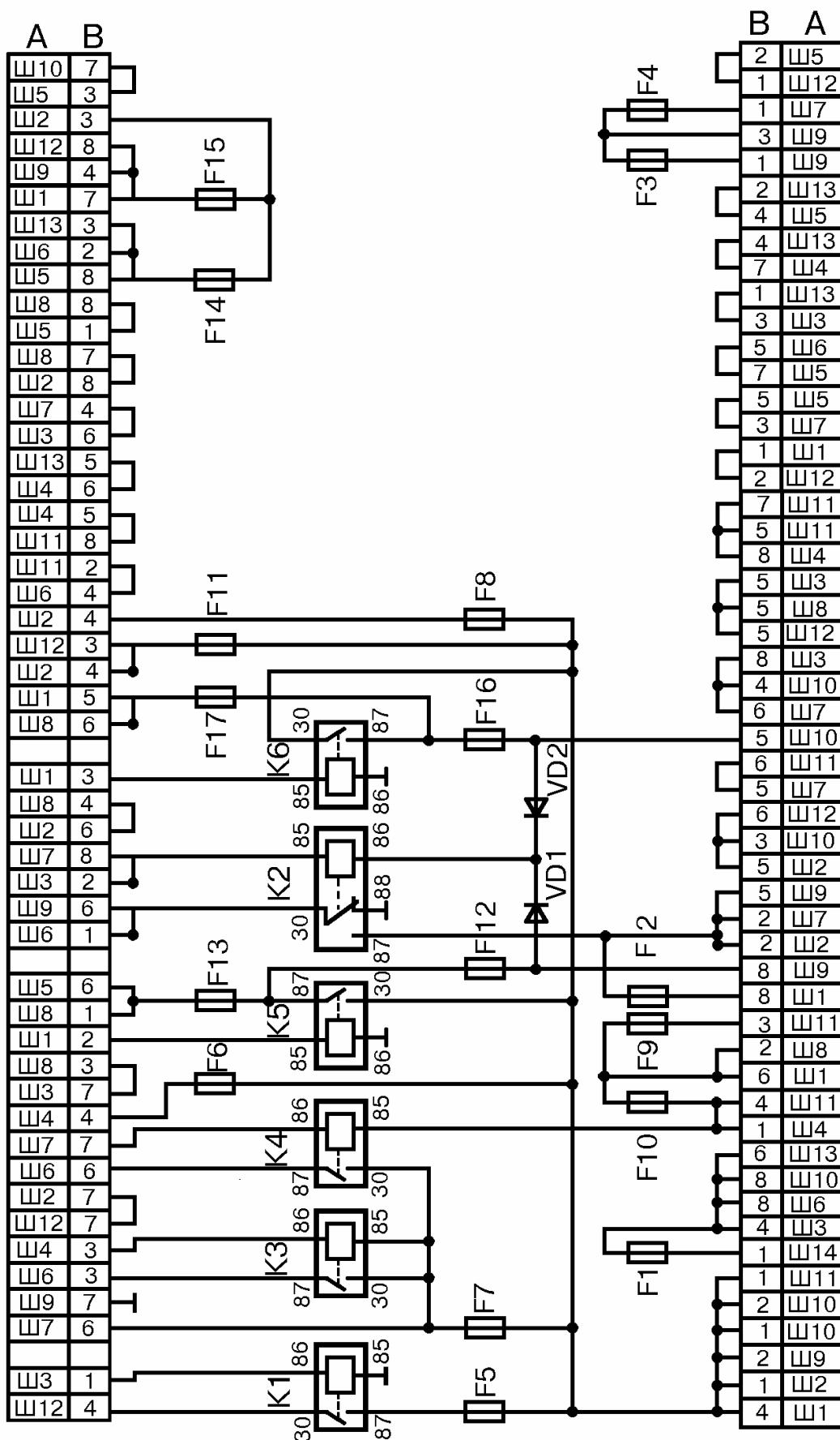
Рис. 4 Принципиальная схема внутренних соединений монтажного блока 2105.
