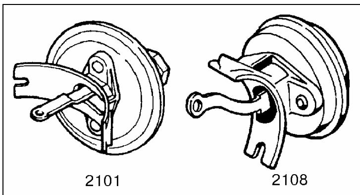
Рис.13 Вакуумный корректор.
