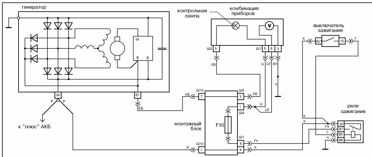
Рис.17 Схема электрических соединений генератора 2108-3701010 на а/м ВАЗ-2107.
