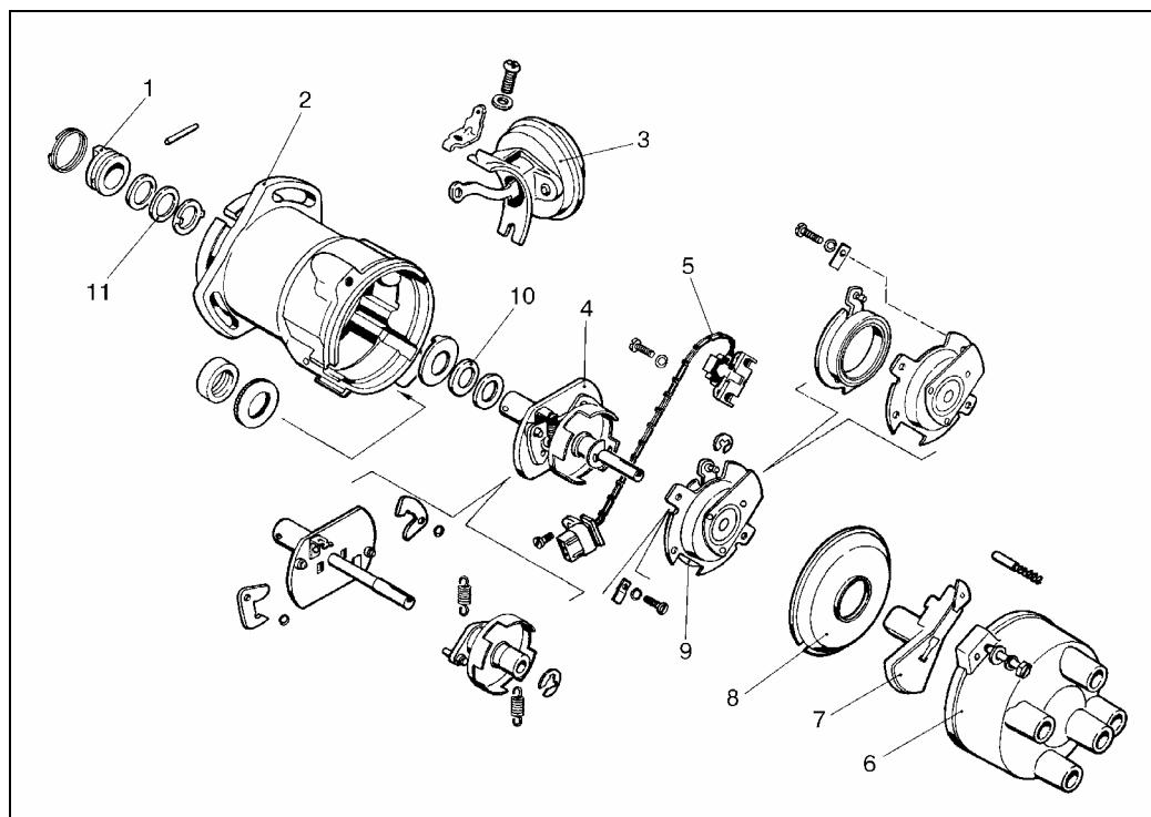
Рис.11 Детали датчика-распределителя 2108.
