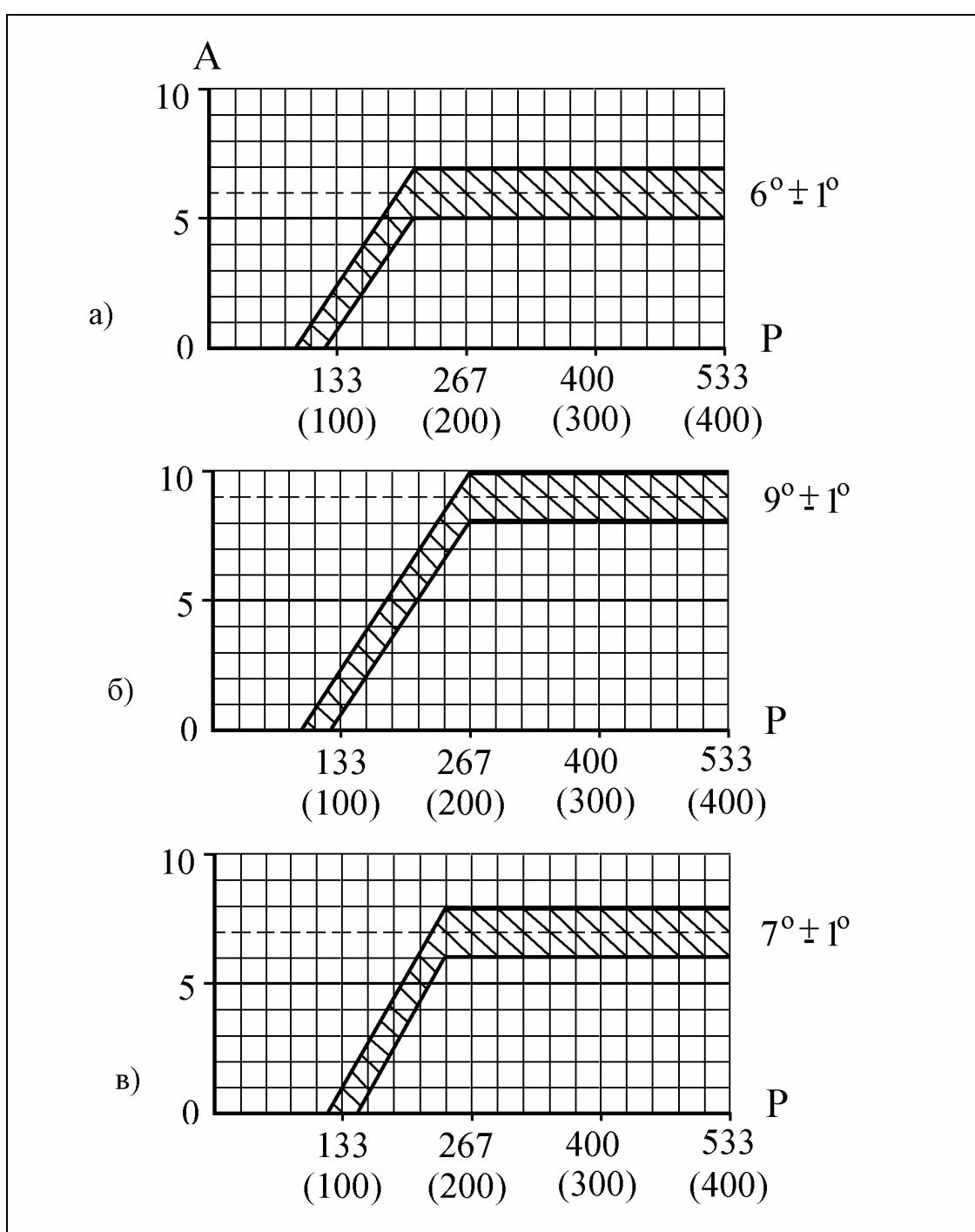
Рис.23 Характеристика вакуумного регулятора распределителя.
