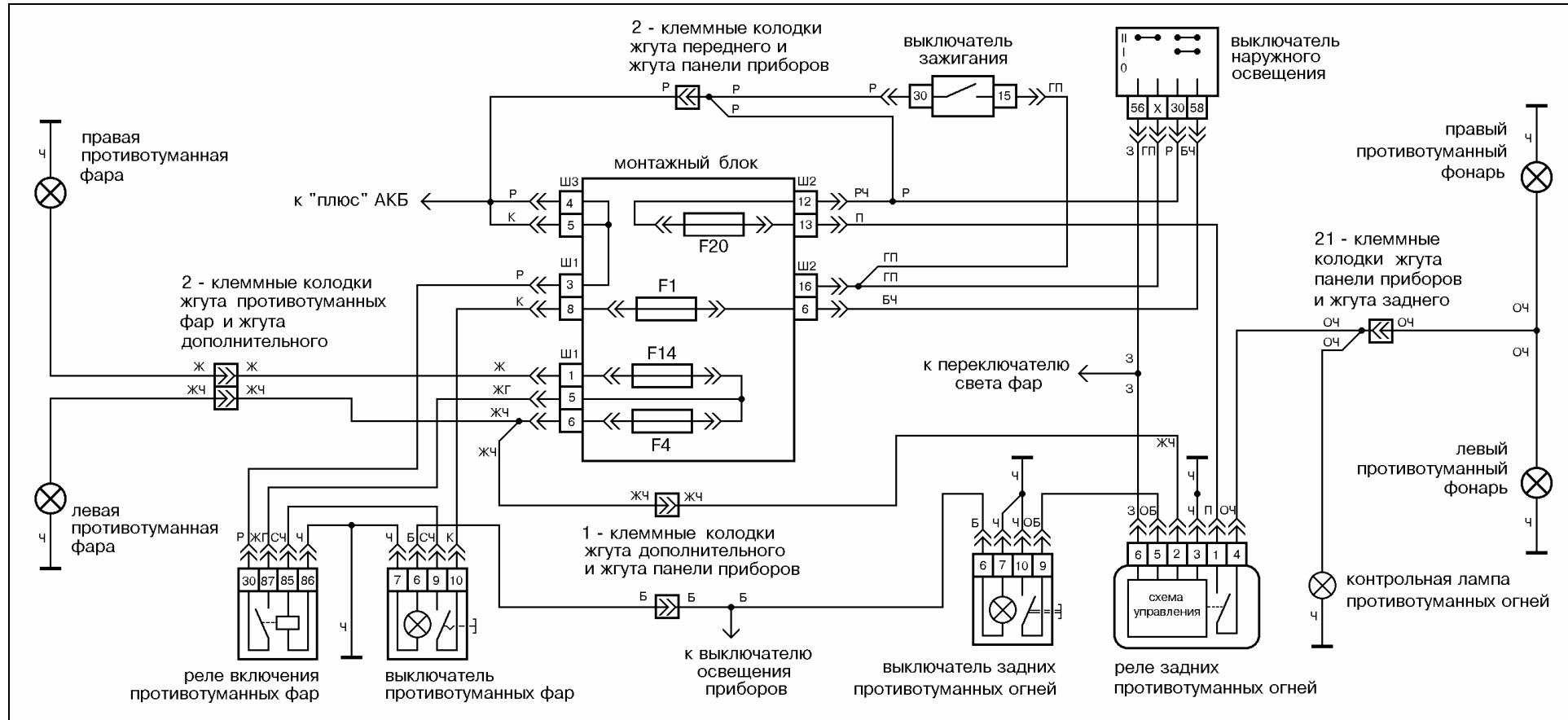
Рис.11 Схема включения задних противотуманных фонарей на а/м ВАЗ-2110.
