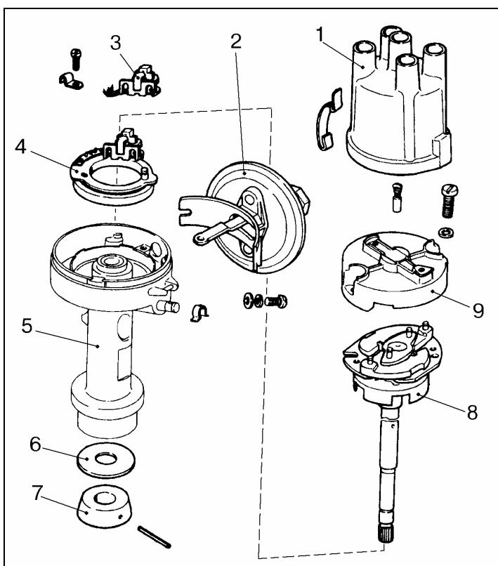
Рис.10 Детали датчиков-распределителей 2105, 2107 и 21213 (БС3).
