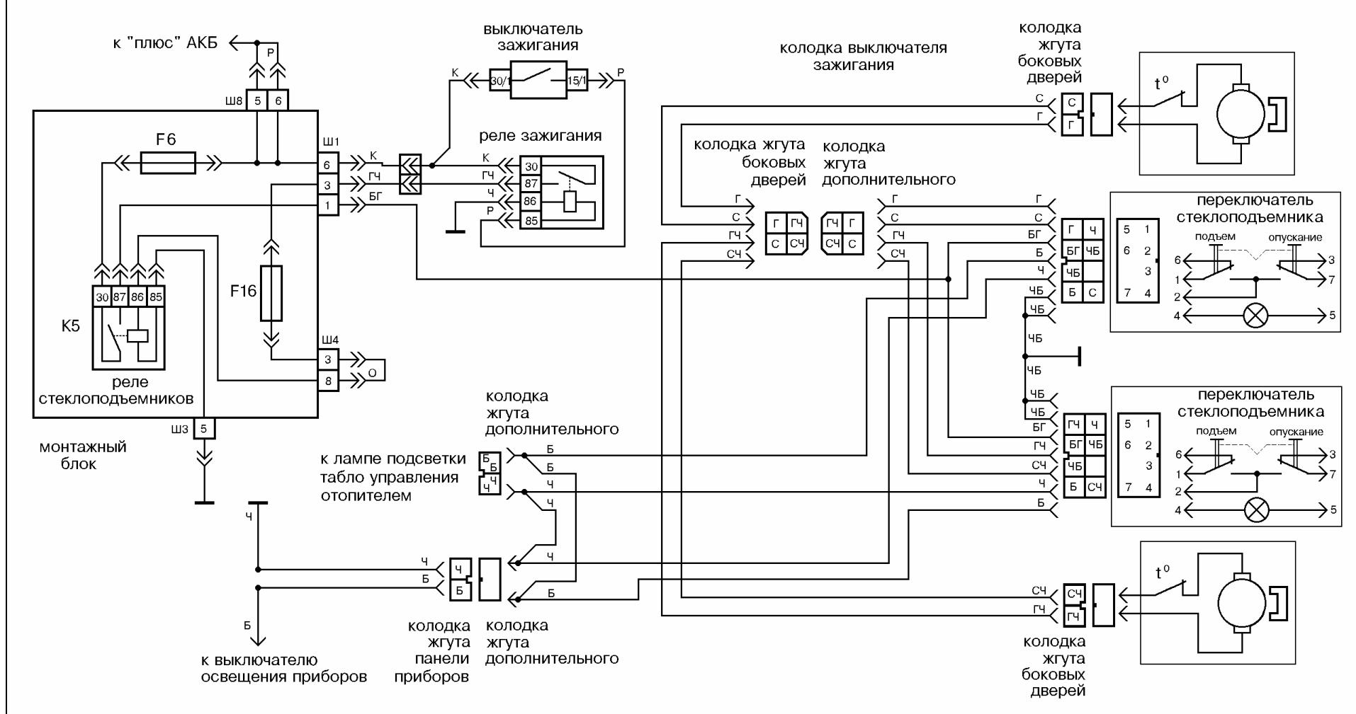
Рис.3 Схема электрических соединений электроствеклоподъемников на а/м ВАЗ-21093, 099.
