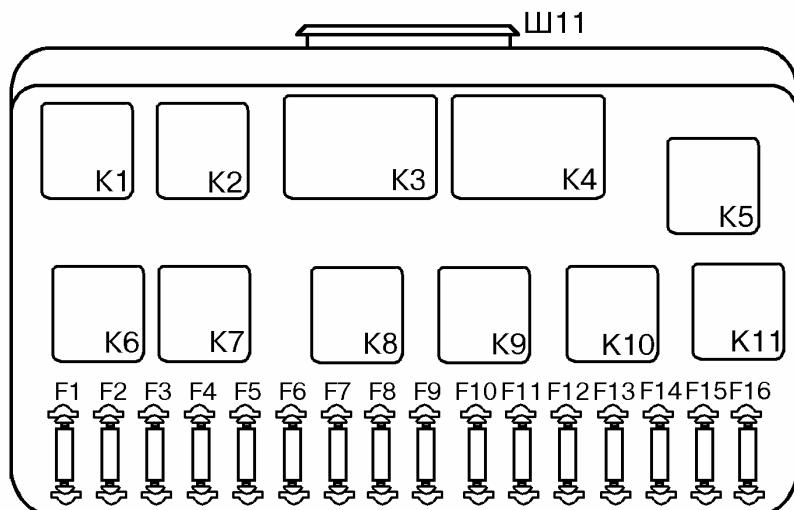
Рис.5 Расположение реле и предохранителей в монтажном блоке 2108
