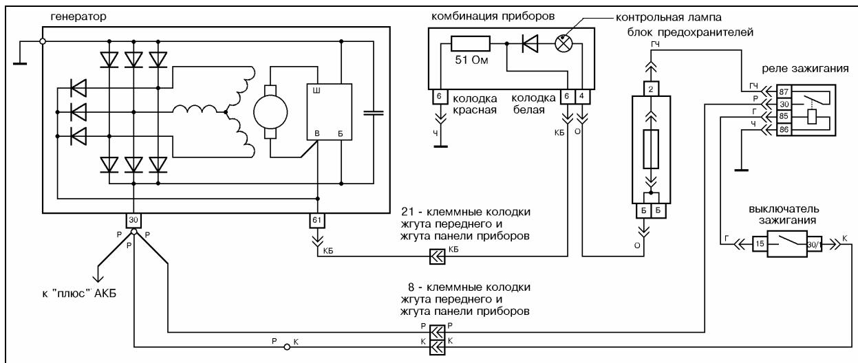
Рис.18 Схема электрических соединений генератора 21213-3701010 на а/м ВАЗ-21213.
