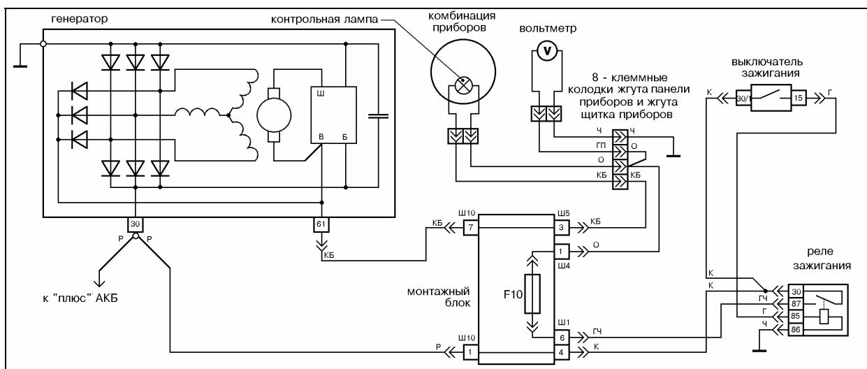
Рис.16 Схема электрических соединений генератора 2108-3701010 на а/м ВАЗ-2104,
