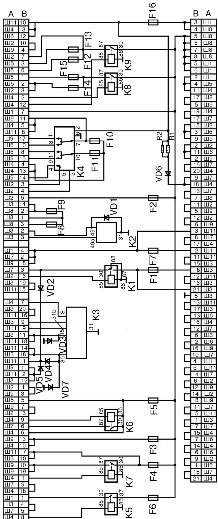
Рис. 15. Принципиальная схема внутренних соединений монтажного блока 2114.
