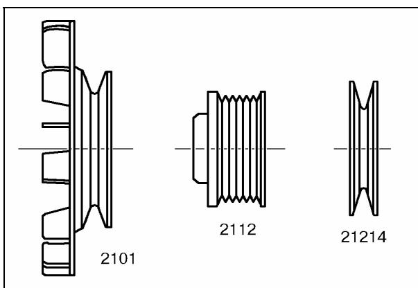
Рис.3 Шкивы генераторов.
