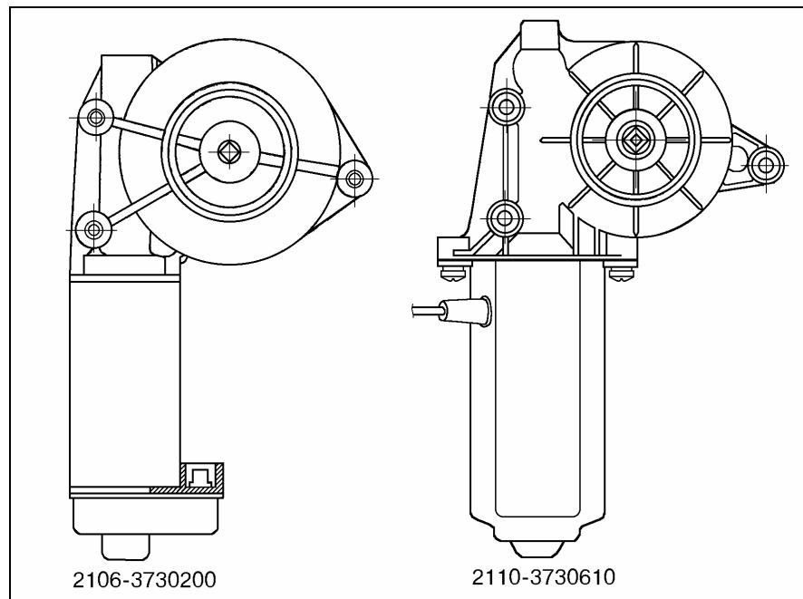
Рис.1 Моторедукторы электростеклоподъемников.
