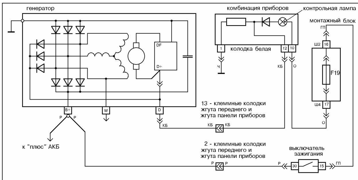
Рис.20 Схема электрических соединений генератора 2112-3701010 на а/м ВАЗ-2110, 2111, 2112.
