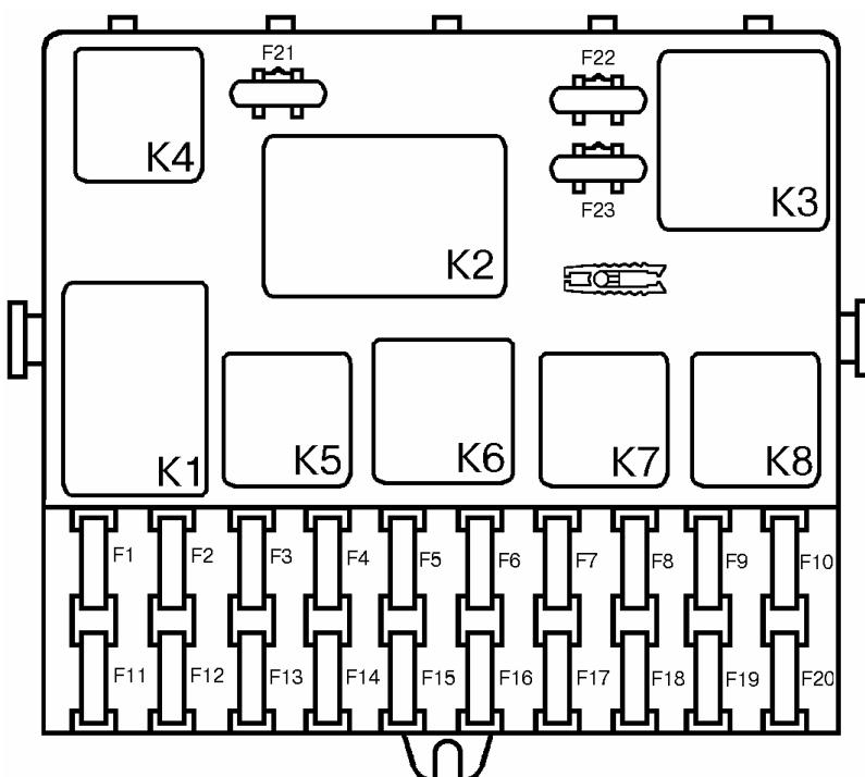
Рис.9. Расположение реле и предохранителей в монтажном блоке 2110-3722010-01
