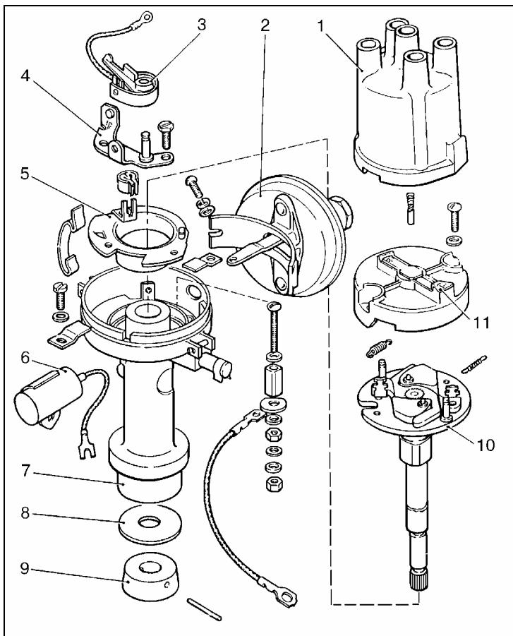
Рис.9 Детали распределителей-прерывателей 2101 и 2103.
