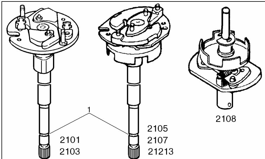
Рис.15 Валик с центробежным регулятором в сборе.
