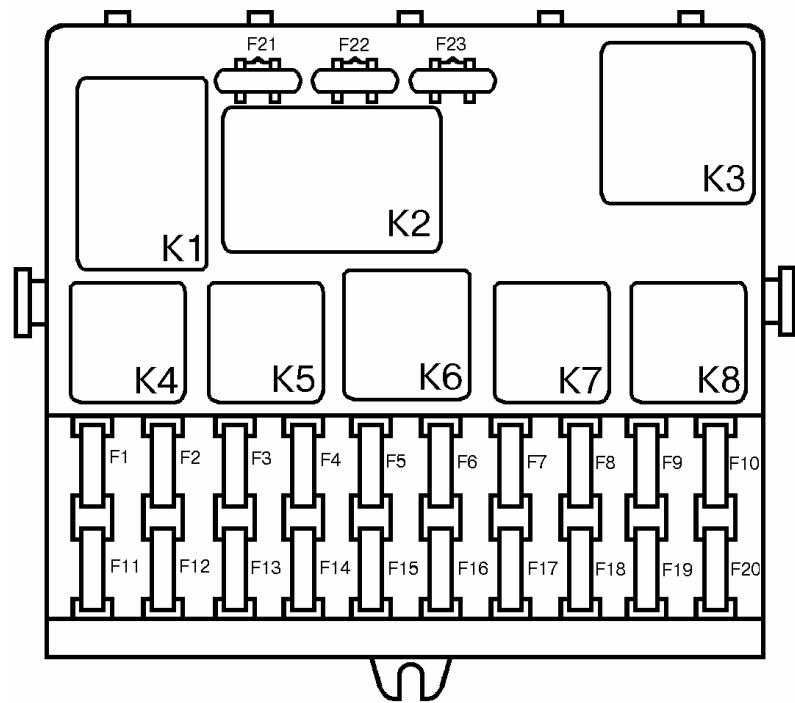
Рис.8. Расположение реле и предохранителей в монтажном блоке 2110-3722010
