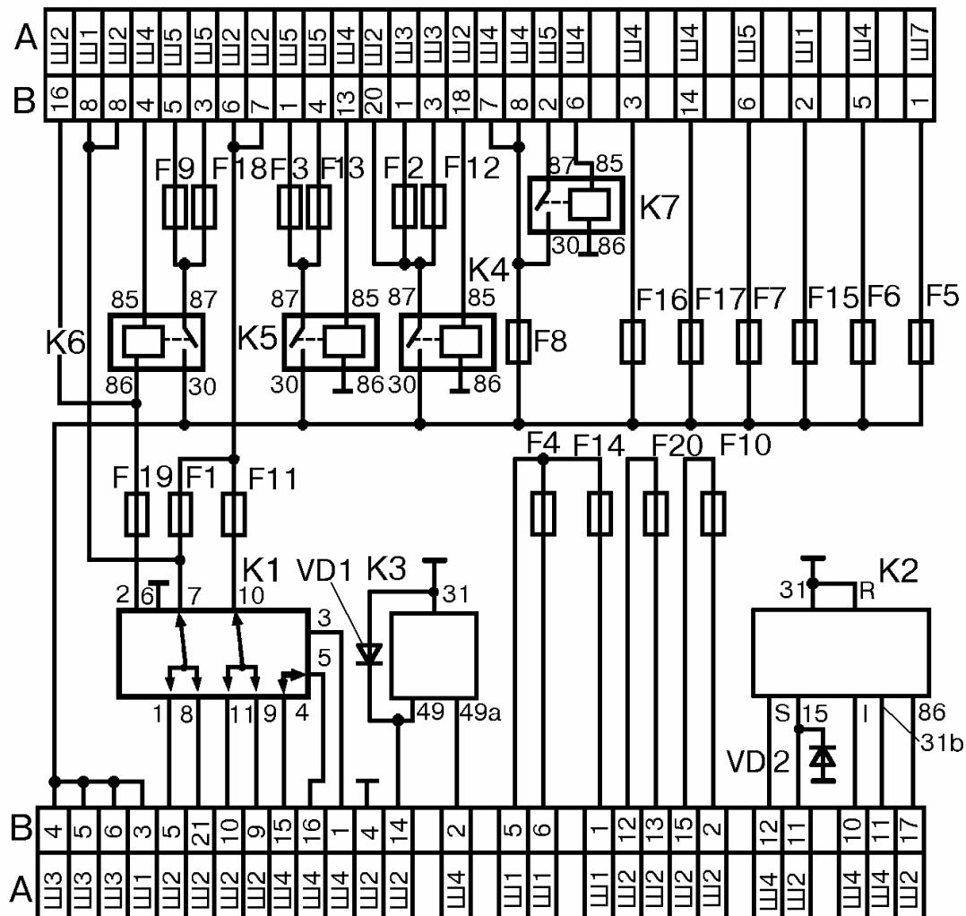
Рис. 12. Принципиальная схема внутренних соединений монтажного блока 2110.
