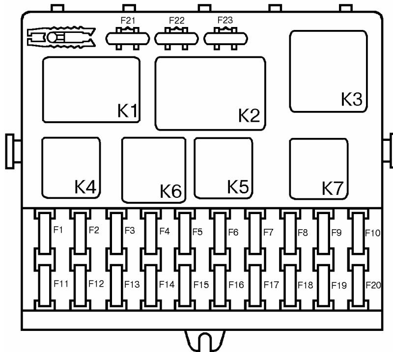
Рис.10. Расположение реле и предохранителей в монтажном блоке 2110-3722010-08.
