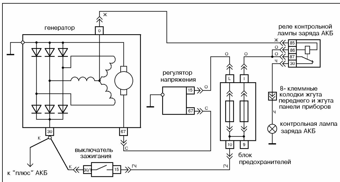
Рис.15 Схема электрических соединений генератора 2101-3701005 на а/м ВАЗ-2101, 2103, 2106.
