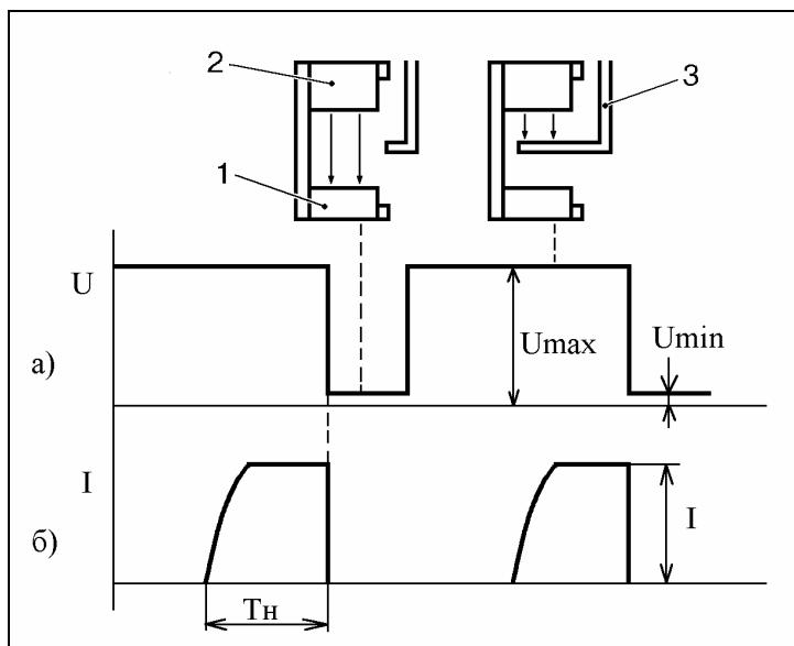
Рис.1 Схема работы бесконтактного датчика.
