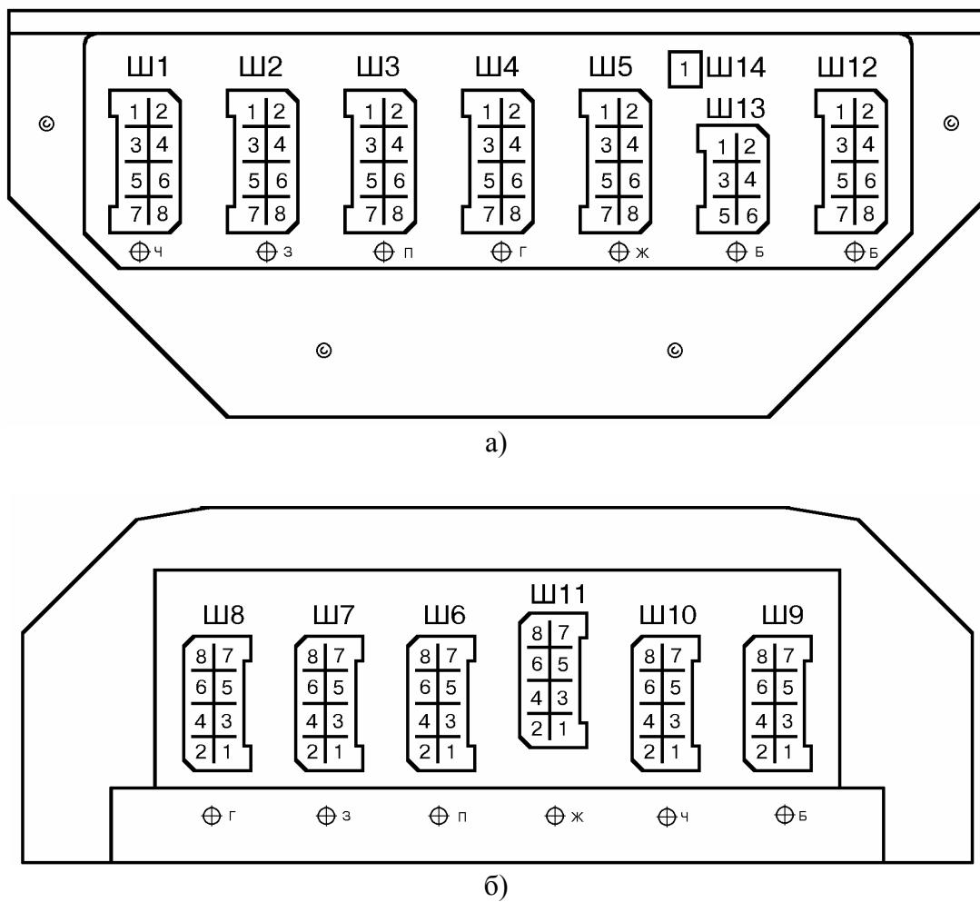
Рис.3 Порядок нумерации штекеров в соединительных колодках монтажного блока 2105.
