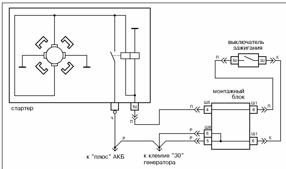
Рис.17 Схема электрических соединений стартера 2108-3708010-06 на а/м ВАЗ-2115.
