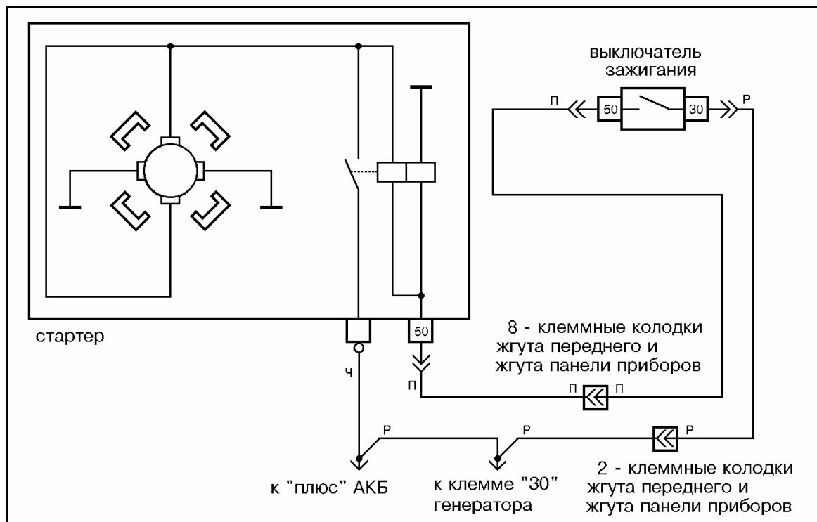
Рис.16 Схема электрических соединений стартера 2110-3708010 на а/м ВАЗ-2110, 2111, 2112.
