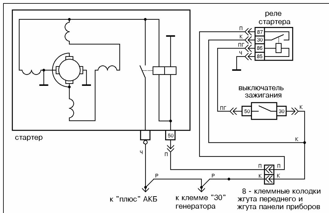
Рис.14 Схема электрических соединений стартера 2101-3708000-02 на а/м ВАЗ-21213.
