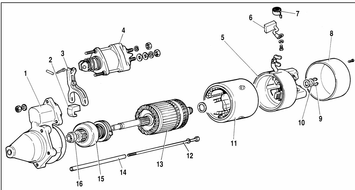
Рис.2 Детали стартера с прямой передачей крутящего момента.
